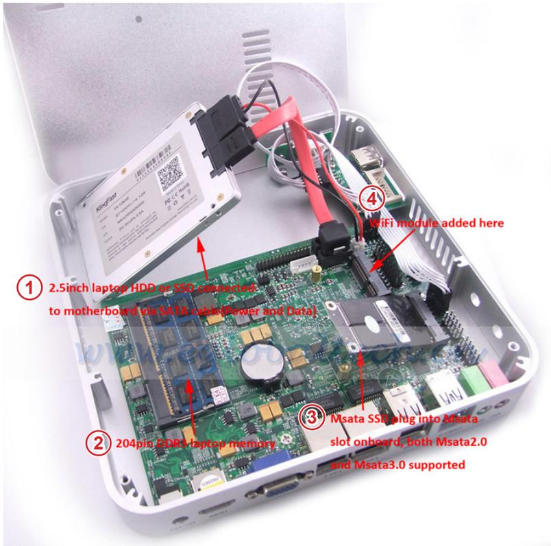
1. Disco duro de 2,5 pulgadas para computadora portátil o SSD conectado a la placa base mediante un cable SATA (alimentación y datos).
