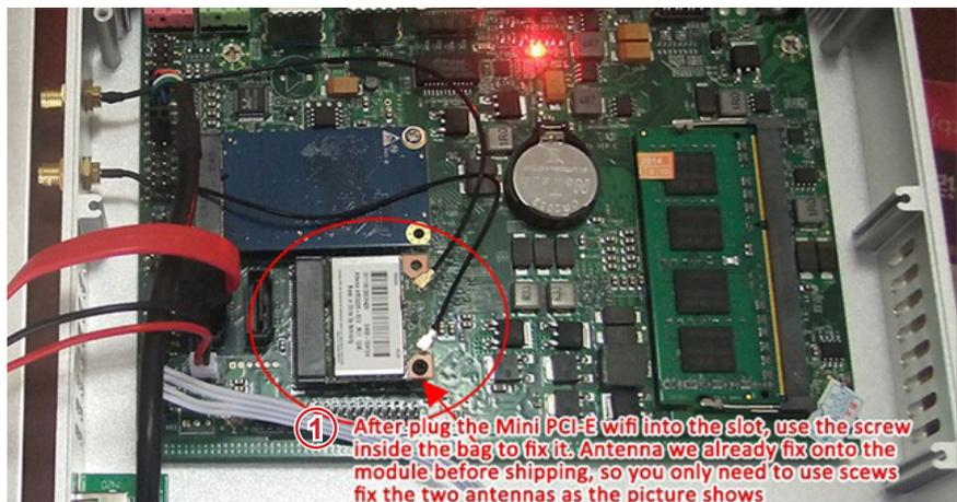
1. Después de conectar el Mini PCI-E WiFi en la ranura, use el tornillo que se incluye dentro de la bolsa para fijarlo. La antena ya está fijada en el módulo de fábrica, por lo que solo necesita atornillar las dos antenas como se muestra en la imagen.
