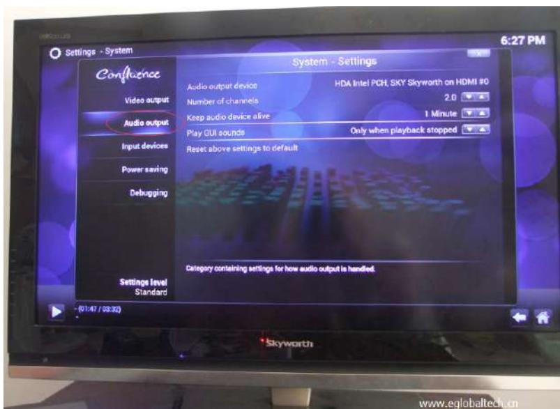
**Paso 5.** Seleccione el dispositivo de salida de audio correcto de la lista que se muestra allí:
