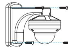
3.Use los tornillos (proporcionados) para fijar el soporte de pared al muro.
