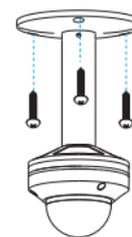
2. Instale el montaje con el soporte al techo con tornillos.
